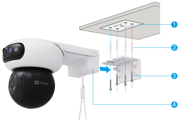
Gbr. 1 Pemasangan pada Plafon
